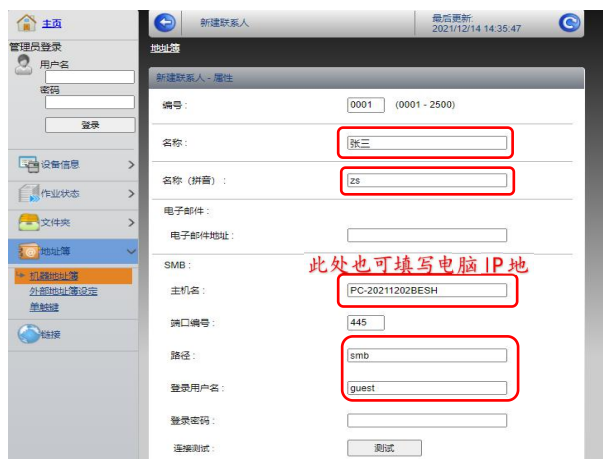
图二 填写信息点击测试正常后拉到最下测点提交, 红框之外勿填写任何信息。(切记密码空) 若测试不正常请检查前面步骤
