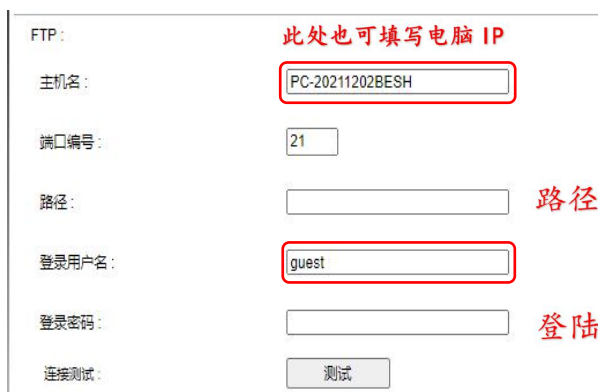
图 3 填写主机名或电脑 IP，填写登陆用户名“guest”测试通过就拉倒最下点击提交，若测试不通，请检查 FTP 设置
